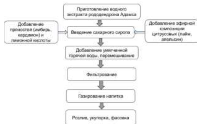
Рисунок 4 - Технологическая схема производства тонизирующего напитка на основе экстракта рододендрона Адамса
