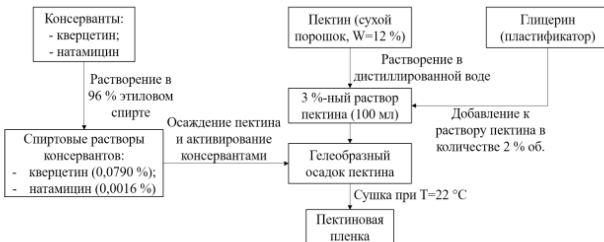
Рисунок 2 – Технологическая схема получения пектиновых пленок
